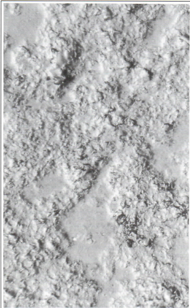
Foto 2. (250x vergroot) Met scherp zand, met een korrel rond de 180 micron, gezandstraald glas van het strand. Uit het gladde oppervlak zijn stukjes glas weggeslagen. Er bleef een pokdalig oppervlak achter. Waar dit zandstralen nog geen effect heeft gehad, zien we dat er nog verhoogde restanten aanwezig zijn van het gladde oppervlak van het glas. Foto: G.J. van Noort.
