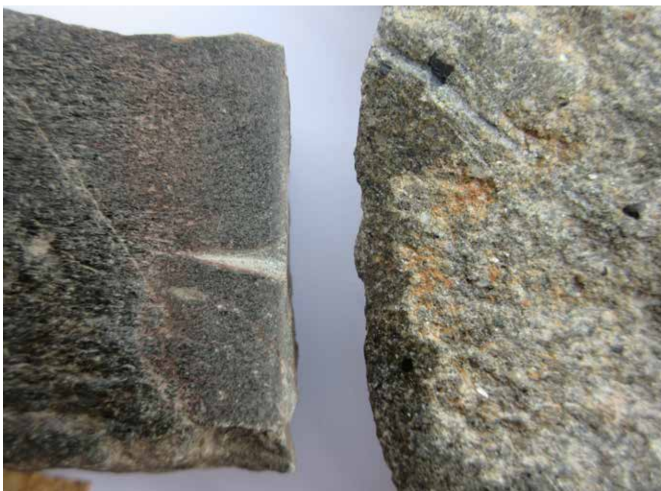
▼ Figuur 8: De textuur van amfiboliet varieert, het linker monster heeft een vezelige en het rechter een korrelige textuur. Experimenteel snijden/zagen en slijpen beïnvloedt de kleur en glans.
